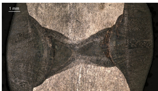
1. ábra: Saválló acél hegesztett kötésének metallográfiai vizsgálata. SmartZoom. Nagyítás 34x
