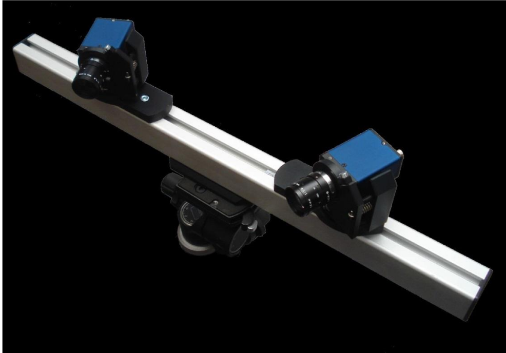
2. ábra. A VIC-3D rendszer főbb elemei [7; 8]
